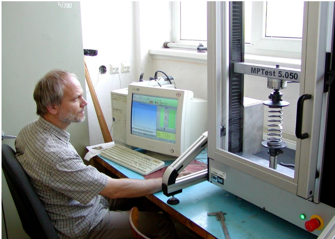
Pružinoměr MP test 5.050, kterým byla dovybavena laboratoř mechaniky pevných těles v roce 2011. Na snímku z roku 2012 přístroj obsluhuje doc. Ing. Vladimír Šleger, CSc.
