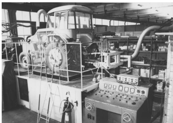
Válcová zkušebna pro tahové zkoušky
