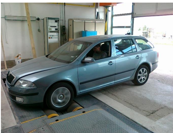
První jízdní zkouška nově sestavené zkušebny
