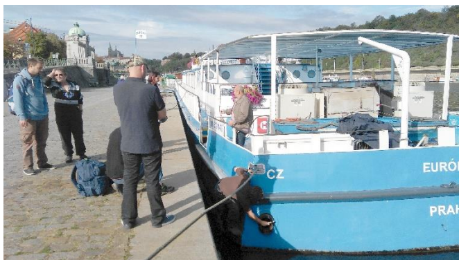
Měření na lodi Európe – instalace sondy do výfuku
