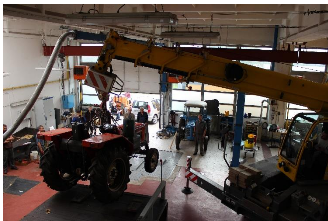
Demontáž traktoru z válcové zkušebny
