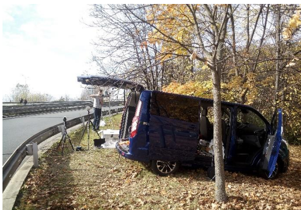
Měření pro Magistrát hl. města Prahy – měření emisí projíždějících vozidel
