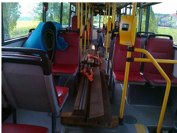
Zatížení autobusu pomocí traverz
