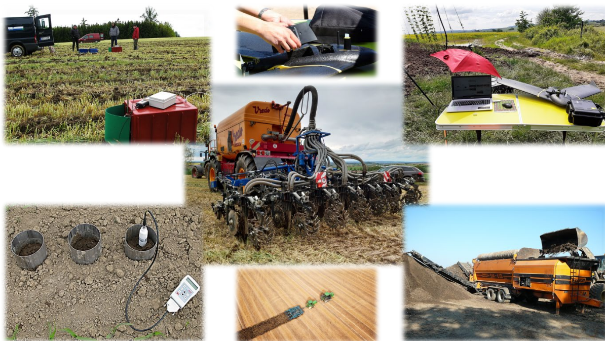
Fotografie z terénních měření prováděných katedrou využití strojů (zleva doprava a shora dolů: měření emisí skleníkových plynů po aplikaci digestátu; snímkování bezpilotním letounem eBee X; aplikátor Vredo se strip-till jednotkou; měření infiltrace; měření tahového odporu; mobilní tříděč odpadu Doppstadt)
