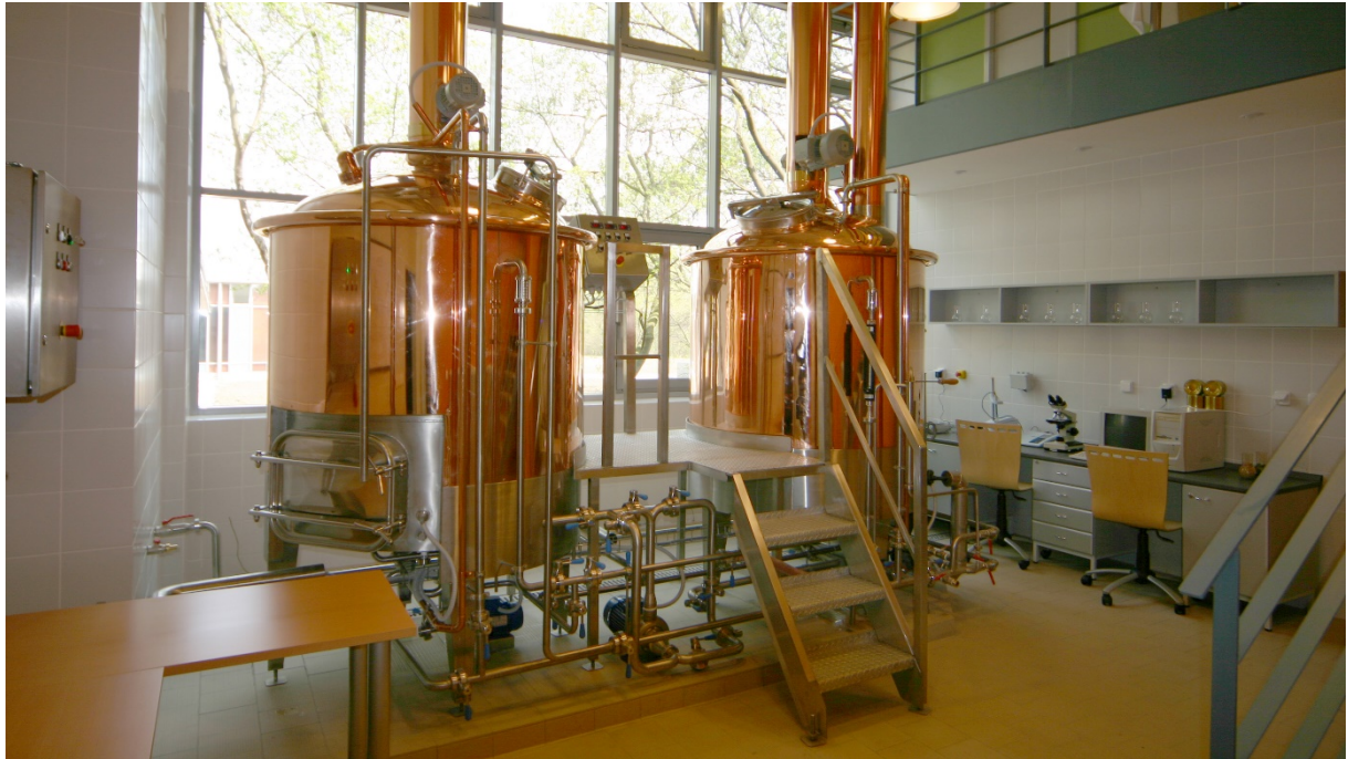
Nerezová dvounádobová varna s měděným opláštěním
