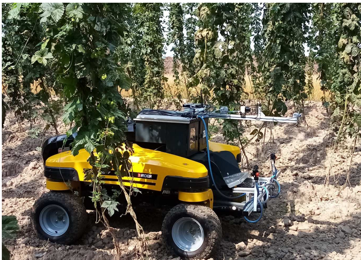
Obr. 4: Robotická platforma na podvozku Spider 3, určená pro sběr dat a polní práce.
