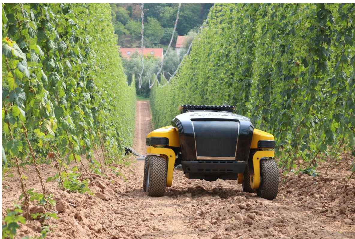
Obr. 6: Robotická platforma na podvozku Spider 3 při aplikaci herbicidů ve chmelnici.
