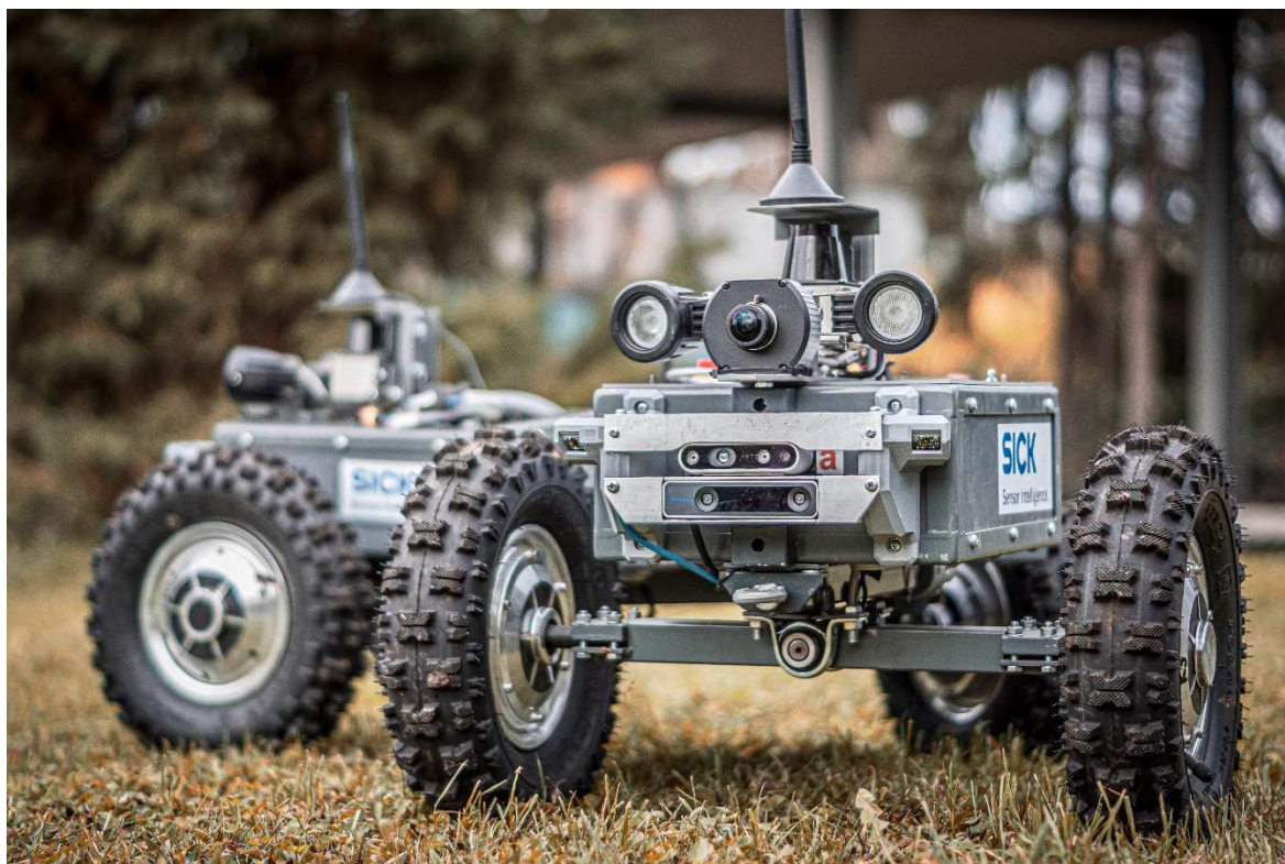
Obr. 2: Robot K2 sestavený na technické fakultě, určený pro plnění úkolů v rámci soutěže DARPA Subterranean Challenge. Robot je rovněž určen k polnímu průzkumu a sběru dat.
