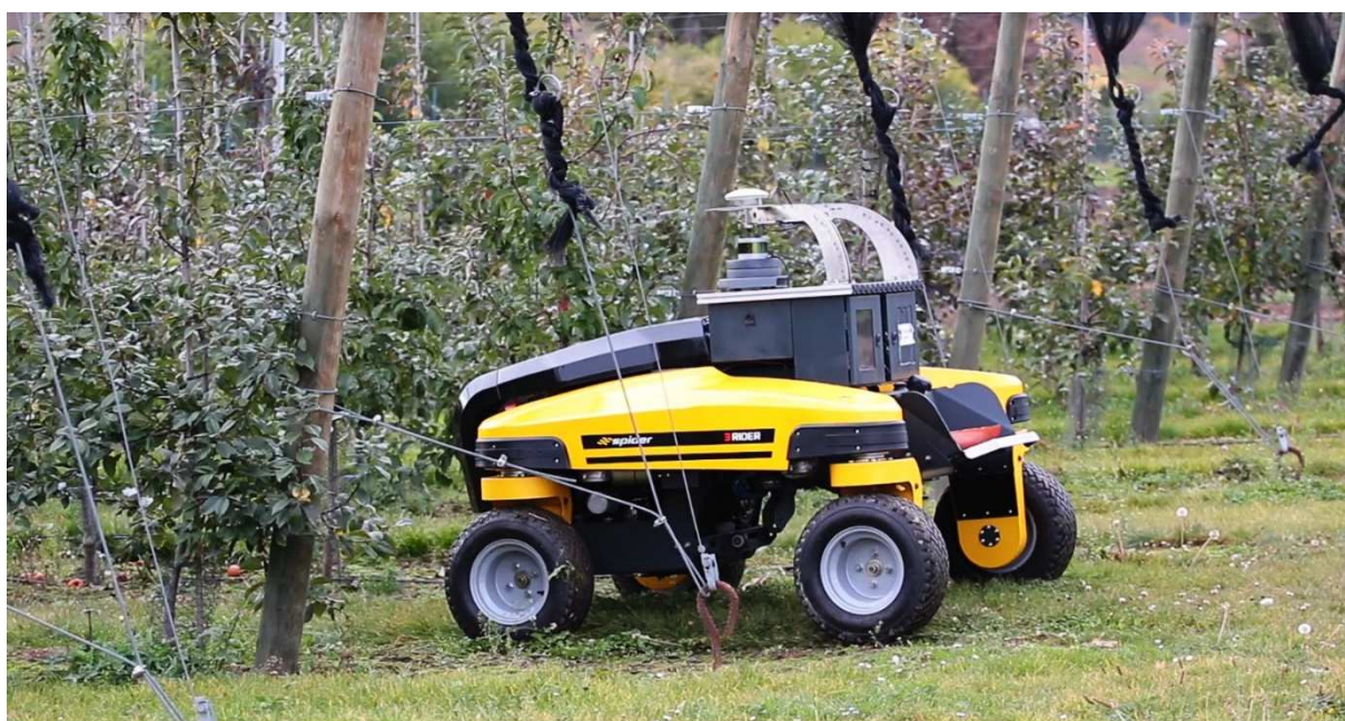
Obr. 8: Robotická platforma na podvozku Spider 3, při sběru dat v ovocném sadu.
