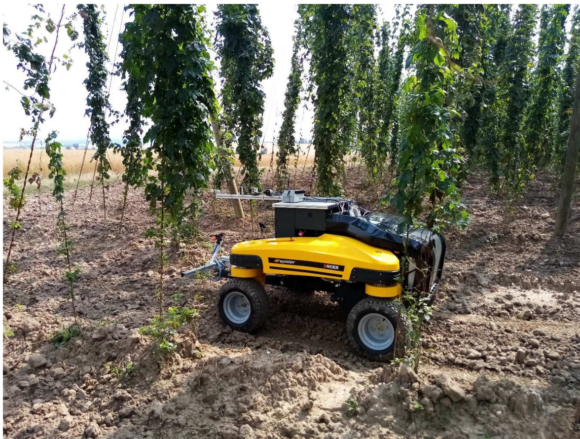
Obr. 5: Robotická platforma na podvozku Spider 3, určená pro sběr dat a polní práce.
