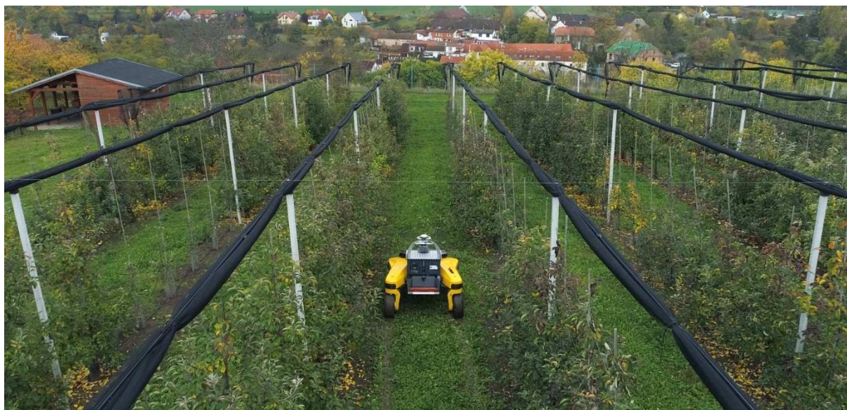
Obr. 9: Robotická platforma na podvozku Spider 3, při sběru dat v ovocném sadu.
