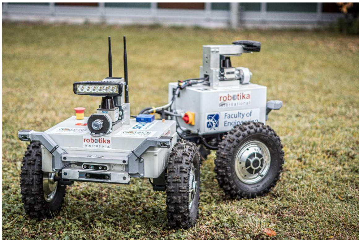
Obr. 1: Robot K2 sestavený na technické fakultě, určený pro plnění úkolů v rámci soutěže DARPA Subterranean Challenge. Robot je rovněž určen k polnímu průzkumu a sběru dat.
