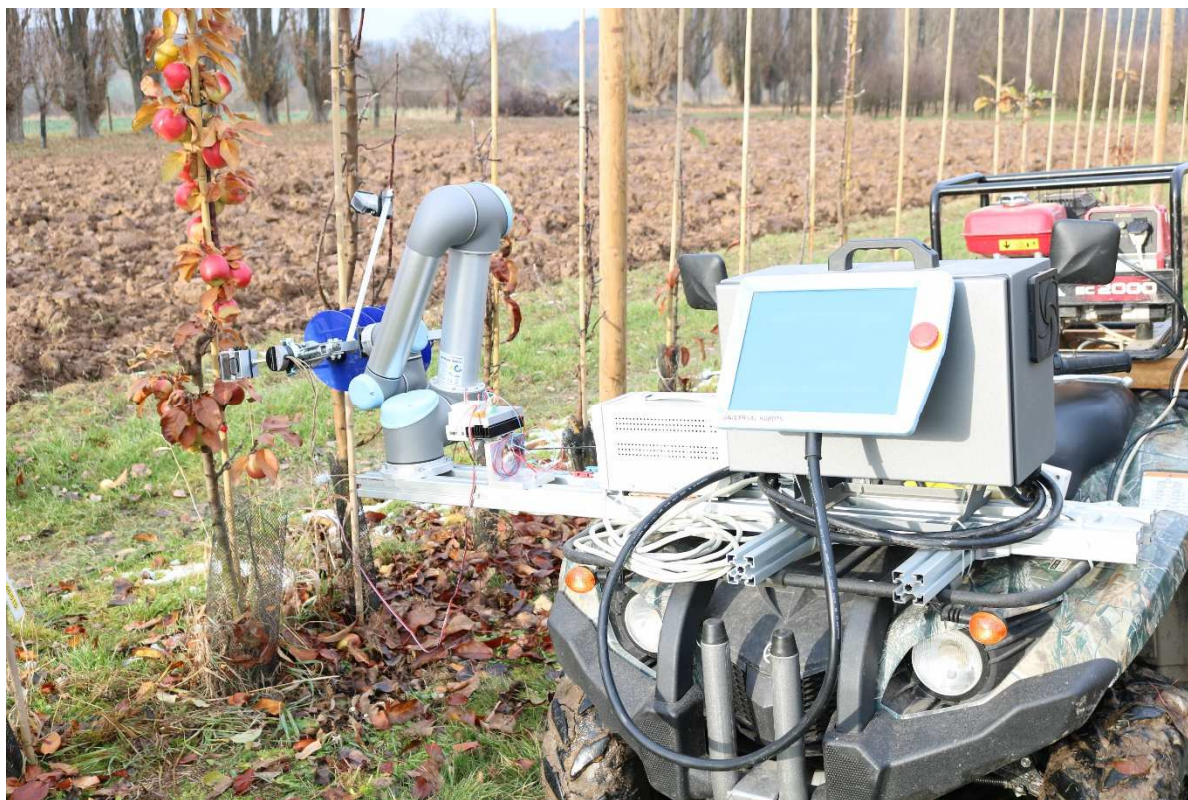
Obr. 3: Vývoj a test prototypu česací hlavy pro robotizovanou sklizeň jablek.
